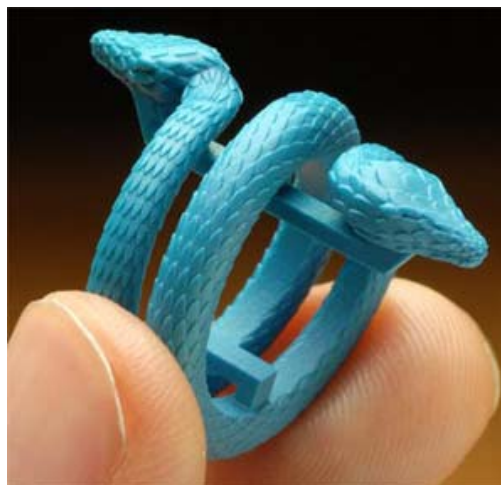
anillo modelado con Rhinoceros y impreso con Solidscape
